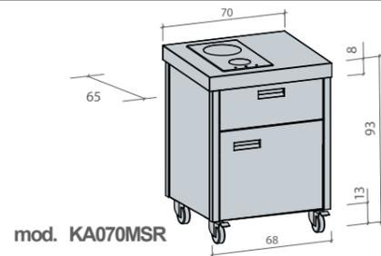
**Modulo con piano cottura induzione Foster 7322.300, Frigorifero Electrolux 43 litri e cassetto soft-closing**
